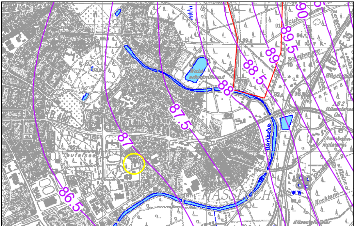
Abbildung 4: Grundwassergleichen April 2001 (Gutachten „Bemessungsgrundwasserstände in Rüsselsheim“, BGS, Darmstadt v. 2006)
