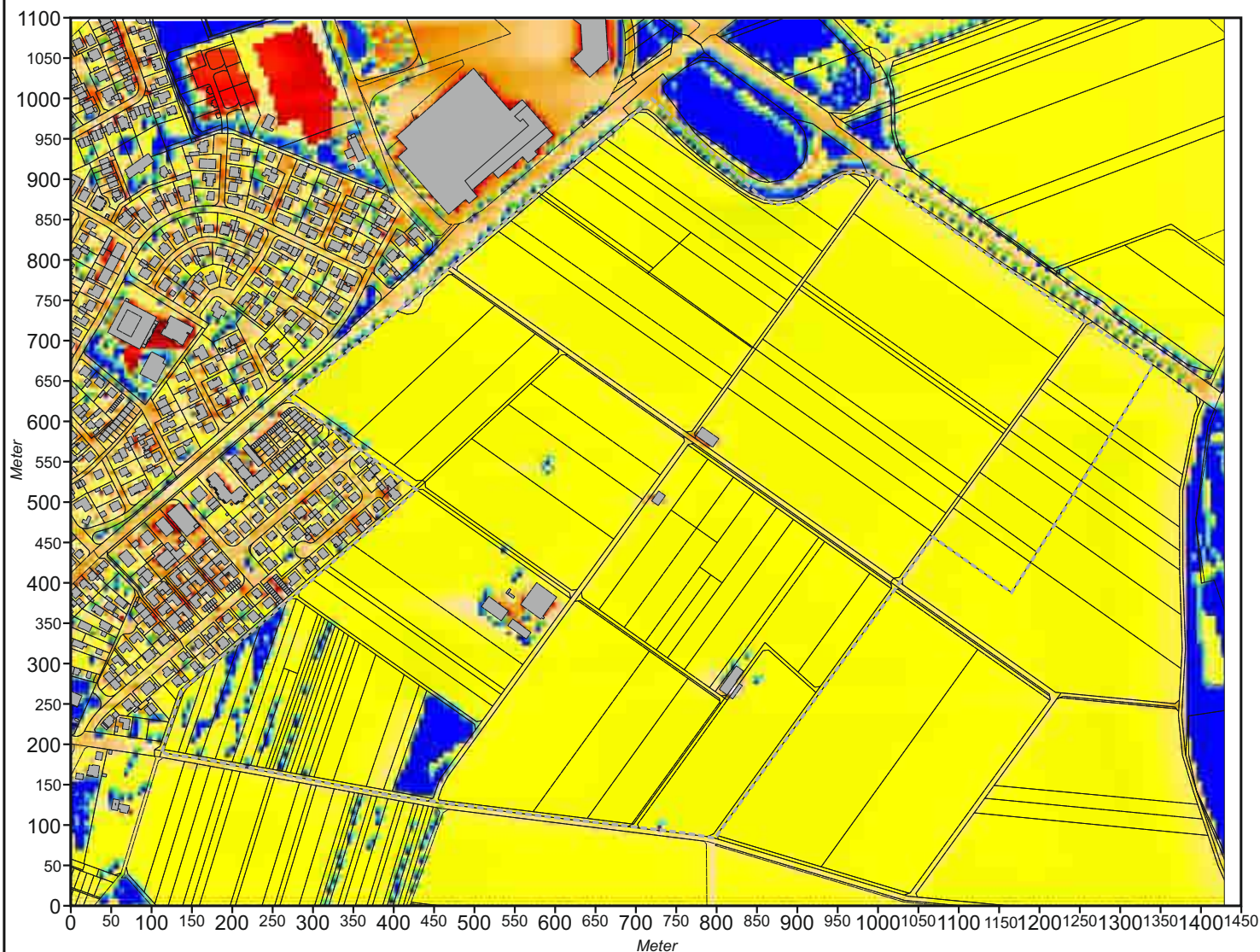
Abb. 32.1 Ist-Zustand, Ergebnisse mikroskaliger Simulationen zum Bioklima (Tagsituation, 14:00 Uhr) PET-Werte 1.5 m ü.G. bei einer großwetterlagenbedingten Anströmung aus Osten (90°) mit 2.5 m/s in einer Höhe von 10 m ü.G.
