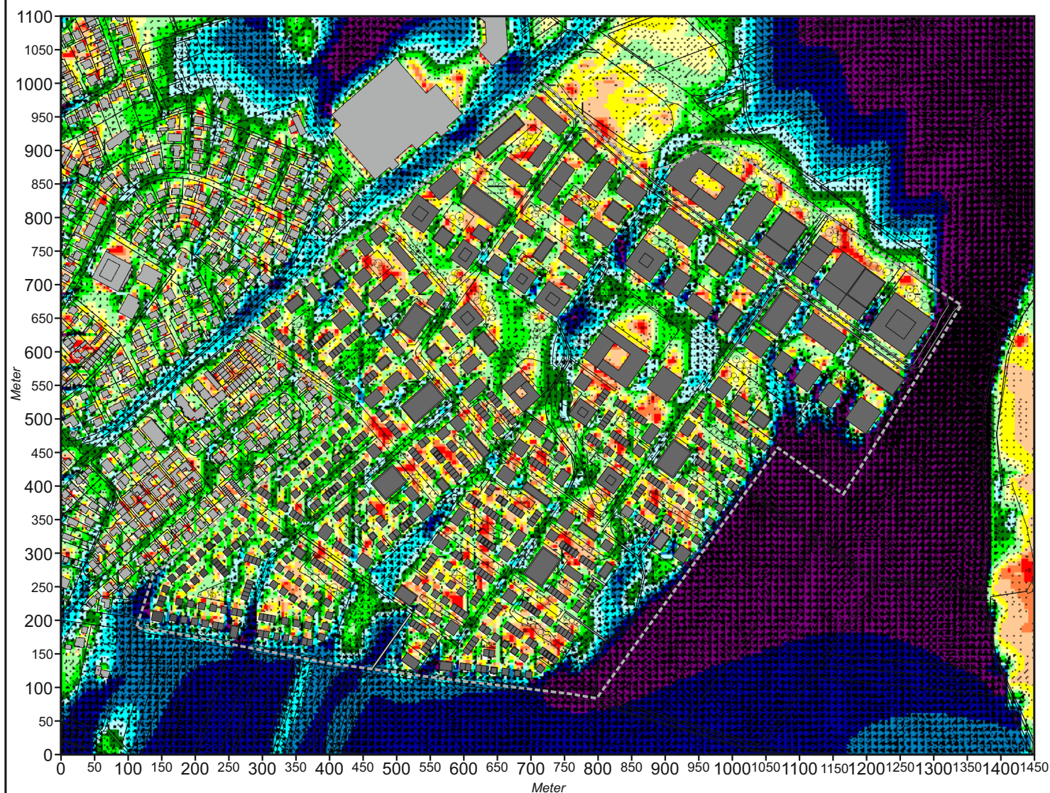
Abb. 18.1 Plan-Zustand, Ergebnisse mikroskaliger Strömungssimulationen Windgeschwindigkeit und Windrichtung 2 m ü.G. bei einer großwetterlagenbedingten Anströmung aus Südsüdwesten (210°) mit 2.5 m/s in einer Höhe von 10 m ü.G.
