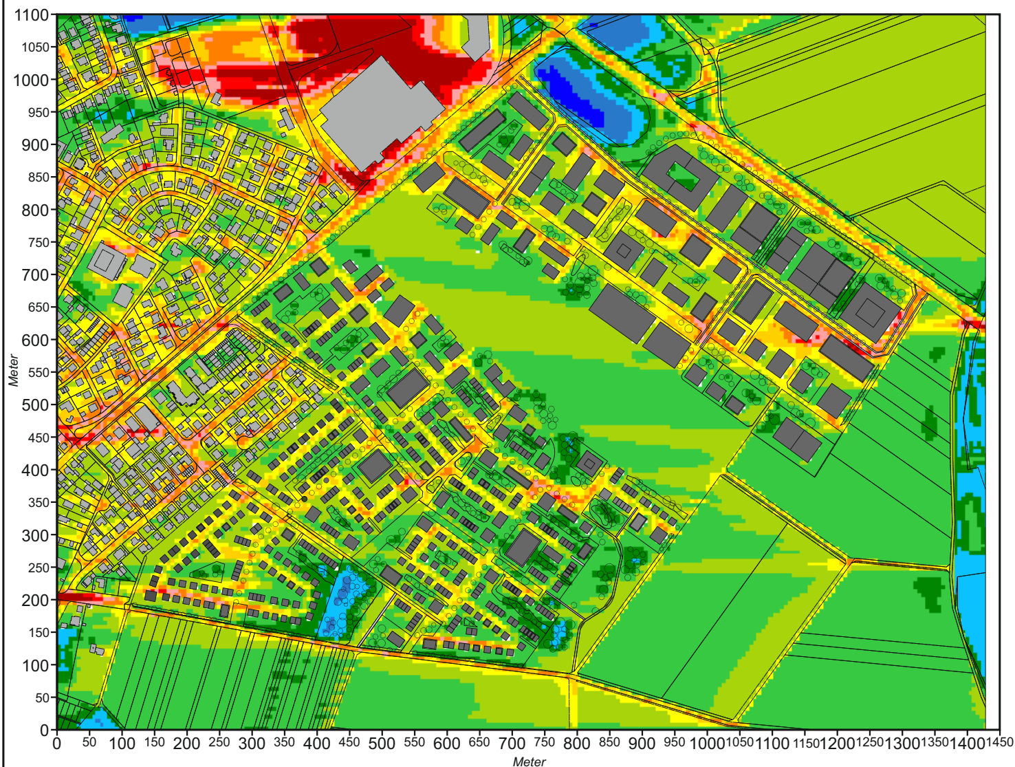
Abb. 31.1 Variante, Ergebnisse mikroskaliger Lufttemperatursimulationen (Tagsituation, 16:00 Uhr) Lufttemperatur 2 m ü.G. bei einer großwetterlagenbedingten Anströmung aus Osten (90°) mit 2.5 m/s in einer Höhe von 10 m ü.G.
