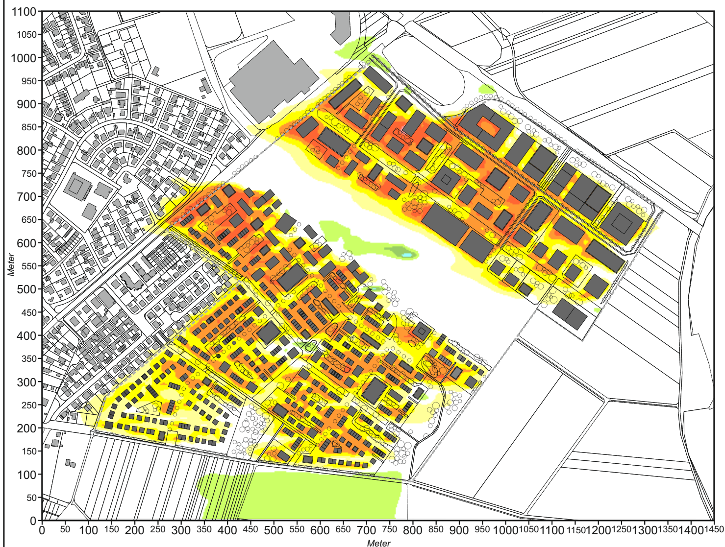
Abb. 28.2 Variante / Vorher-Nachher-Vergleich, Ergebnisse mikroskaliger Strömungssimulationen Planungsbedingte Veränderung der Windgeschwindigkeit 2 m ü.G. bei einer großwetterlagenbedingten Anströmung aus Osten (90°) mit 1.5 m/s in einer Höhe von 15 m ü.G. (Nachtsituation)
