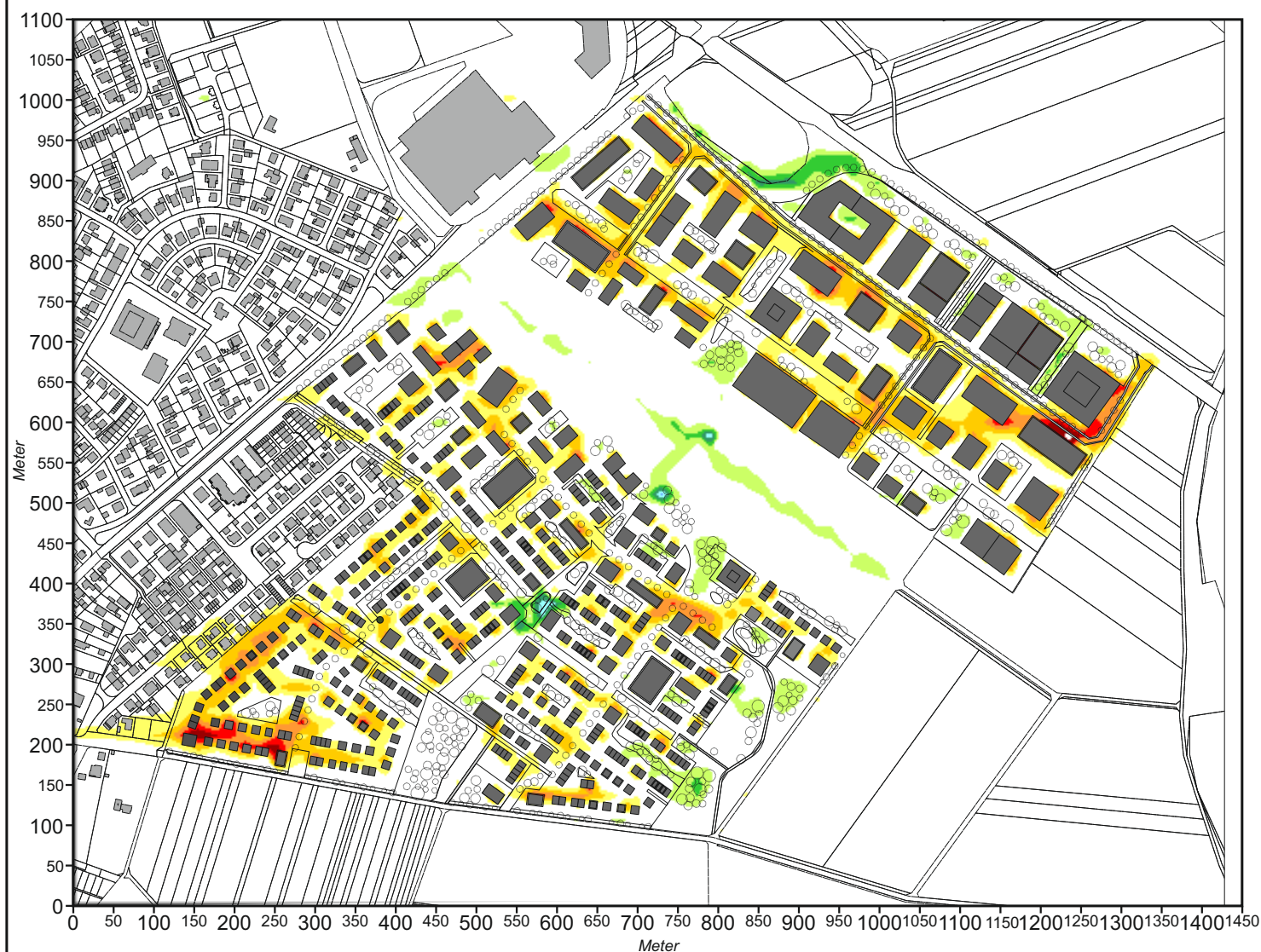
Abb. 31.2 Vorher-Nachher-Vergleich, Ergebnisse mikroskaliger Lufttemperatursimulationen (Tagsituation, 16:00 Uhr) Planungsbedingte Veränderung (Variante) der Lufttemperatur 2 m ü.G. bei einer großwetterlagenbedingten Anströmung aus Osten (90°) mit 2.5 m/s in einer Höhe von 10 m ü.G.
