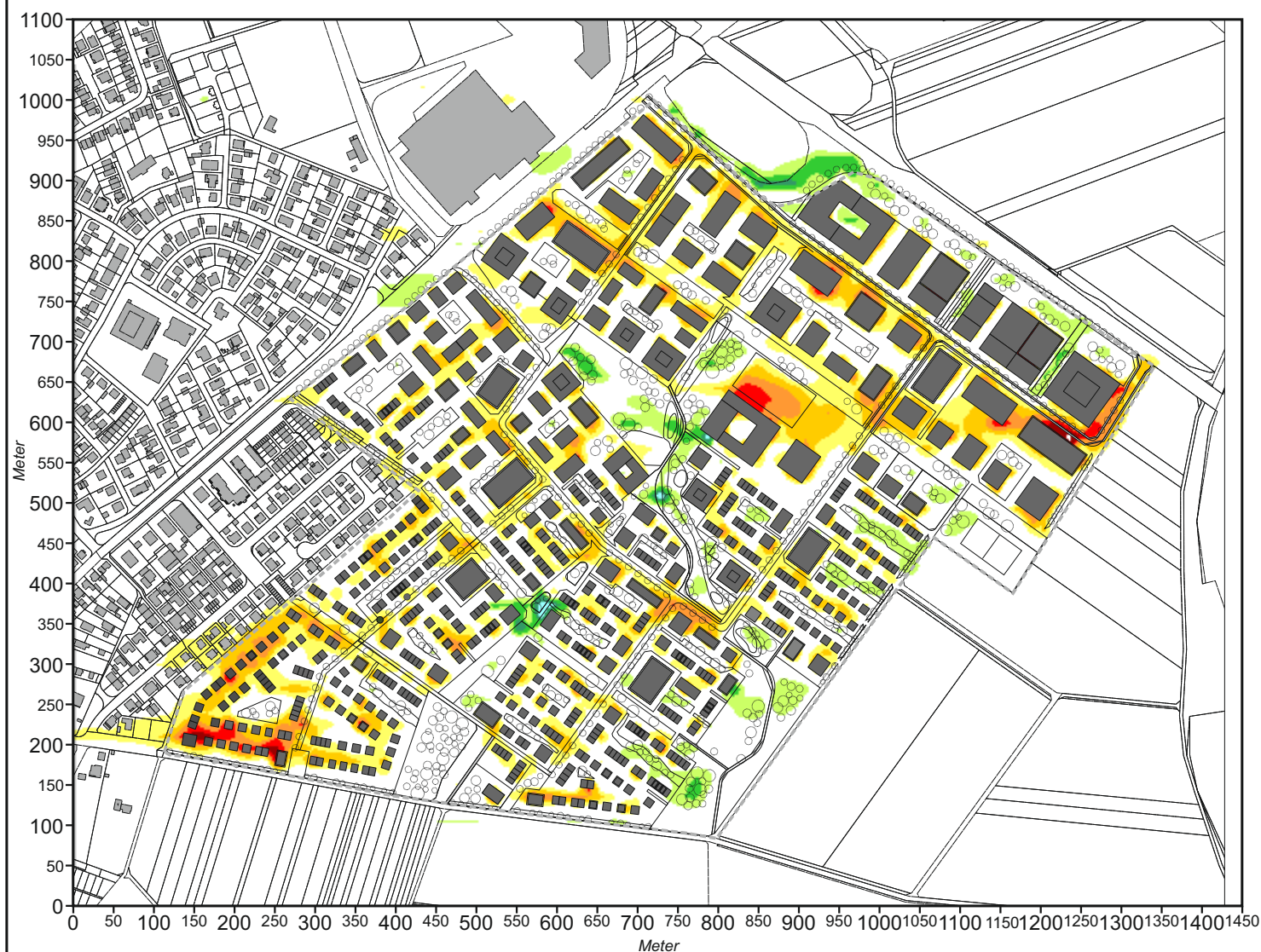
Abb. 30.2 Vorher-Nachher-Vergleich, Ergebnisse mikroskaliger Lufttemperatursimulationen (Tagsituation, 16:00 Uhr) Planungsbedingte Veränderung der Lufttemperatur 2 m ü.G. bei einer großwetterlagenbedingten Anströmung aus Osten (90°) mit 2.5 m/s in einer Höhe von 10 m ü.G.
