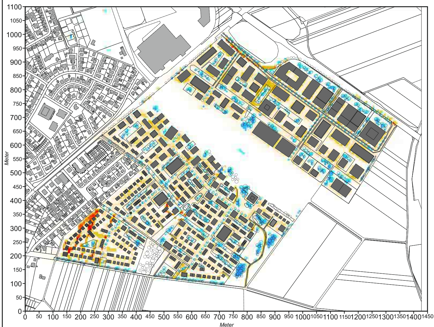
Abb. 32.5 Vorher-Nachher-Vergleich (Variante), Ergebnisse mikroskaliger Simulationen zum Bioklima (Tagsituation, 14:00 Uhr) Planungsbedingte Veränderung der PET-Werte 1.5 m ü.G. bei einer großwetterlagenbedingten Anströmung aus Osten (90°) mit 2.5 m/s in einer Höhe von 10 m ü.G.
