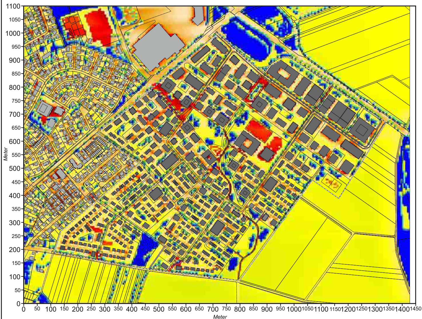
Abb. 32.2 Plan-Zustand, Ergebnisse mikroskaliger Simulationen zum Bioklima (Tagsituation, 14:00 Uhr) PET-Werte 1.5 m ü.G. bei einer großwetterlagenbedingten Anströmung aus Osten (90°) mit 2.5 m/s in einer Höhe von 10 m ü.G.
