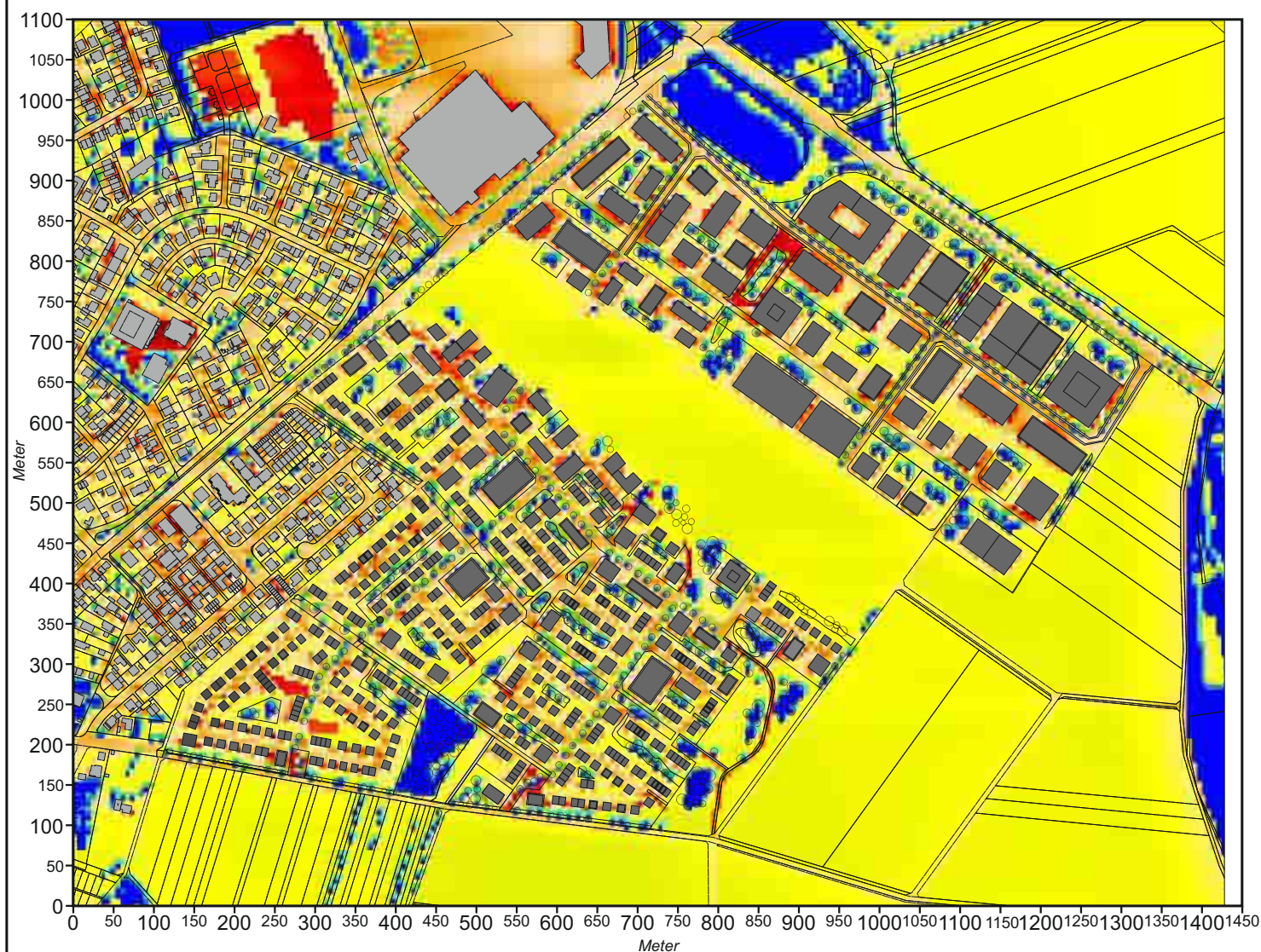
Abb. 32.4 Variante, Ergebnisse mikroskaliger Simulationen zum Bioklima (Tagsituation, 14:00 Uhr) PET-Werte 1.5 m ü.G. bei einer großwetterlagenbedingten Anströmung aus Osten (90°) mit 2.5 m/s in einer Höhe von 10 m ü.G.
