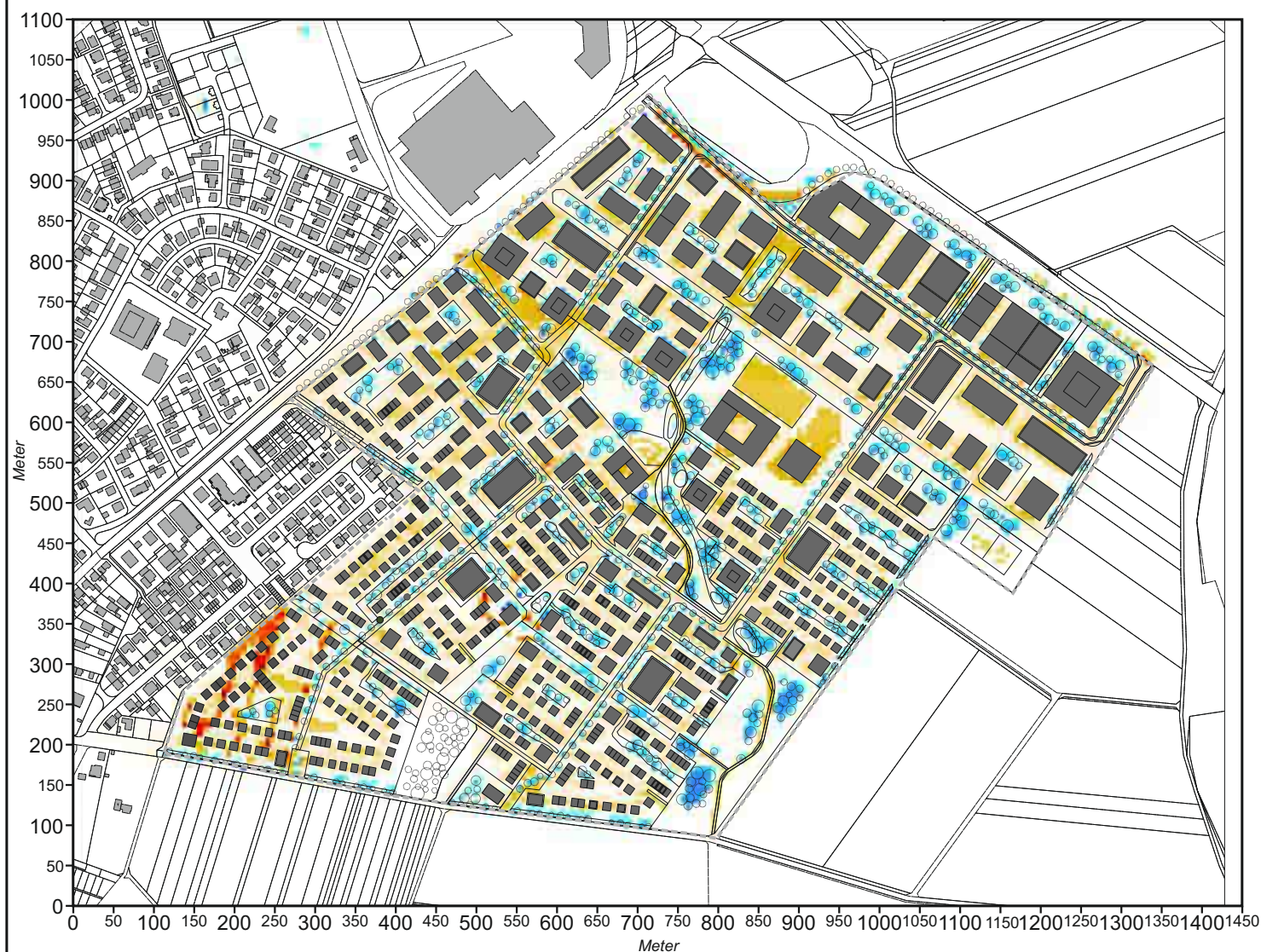
Abb. 32.3 Vorher-Nachher-Vergleich, Ergebnisse mikroskaliger Simulationen zum Bioklima (Tagsituation, 14:00 Uhr) Planungsbedingte Veränderung der PET-Werte 1.5 m ü.G. bei einer großwetterlagenbedingten Anströmung aus Osten (90°) mit 2.5 m/s in einer Höhe von 10 m ü.G.
