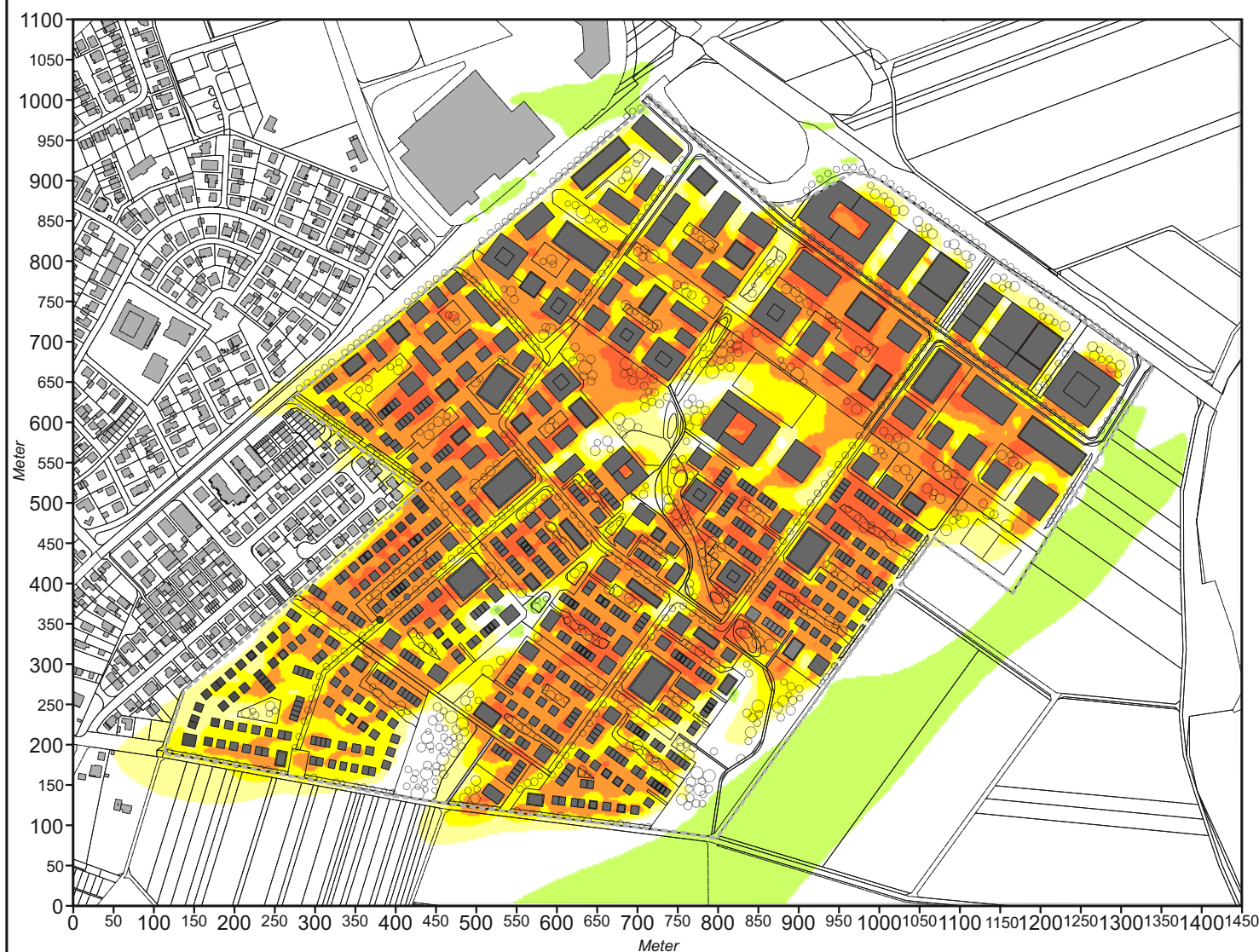
Abb. 24.2 Vorher-Nachher-Vergleich, Ergebnisse mikroskaliger Strömungssimulationen Planungsbedingte Veränderung der Windgeschwindigkeit 2 m ü.G. bei einer großwetterlagenbedingten Anströmung aus Ostnordosten (60°) mit 1.5 m/s in einer Höhe von 15 m ü.G. (Nachtsituation)
