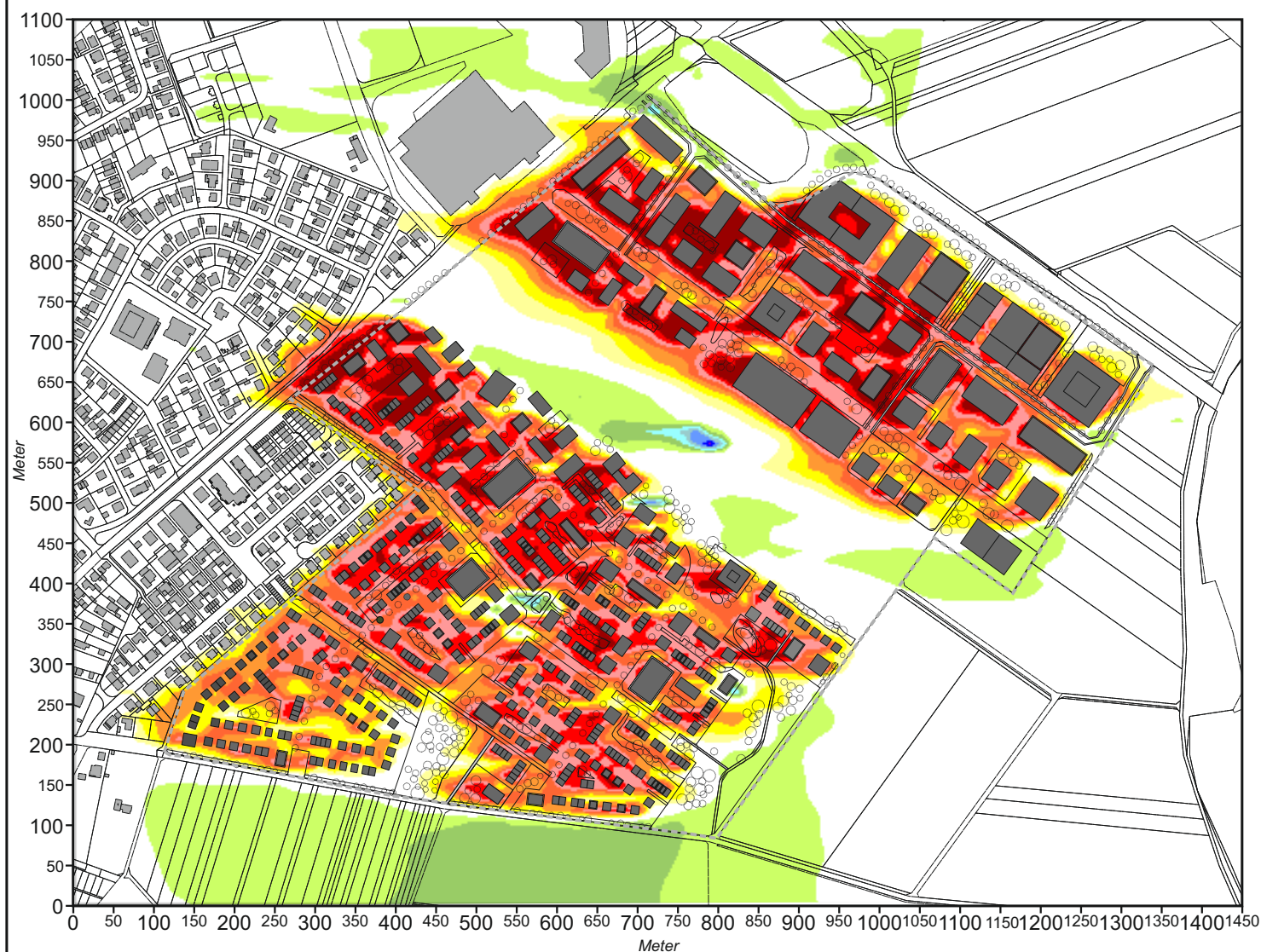
Abb. 22.2 Variante / Vorher-Nachher-Vergleich, Ergebnisse mikroskaliger Strömungssimulationen Planungsbedingte Veränderung der Windgeschwindigkeit 2 m ü.G. bei einer großwetterlagenbedingten Anströmung aus Osten (90°) mit 2.5 m/s in einer Höhe von 10 m ü.G.
