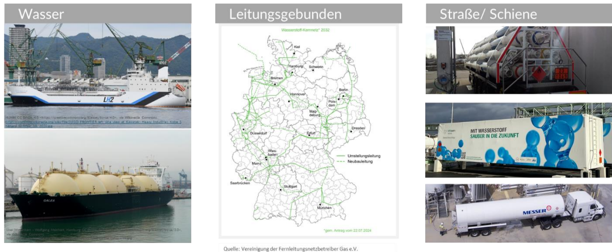
Abbildung 2-7: Transportarten von Wasserstoff
