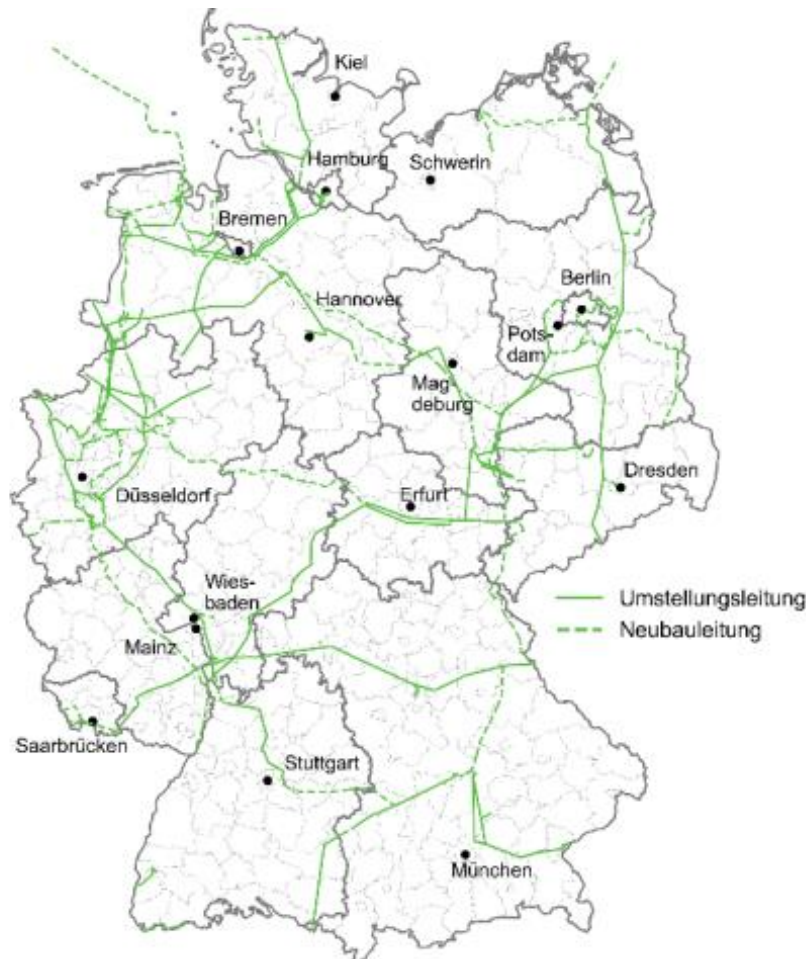
Abbildung 2-6: Die in Deutschland genehmigten (am 22.10.24) Wasserstofftransportleitungen des Wasserstoff-Kernnetzes 2032 (FNBGas)
