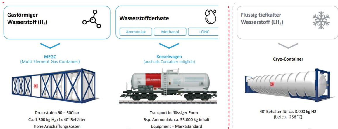
Abbildung 3-20: Formen des schienenengebundenen Wasserstofftransports (35)
