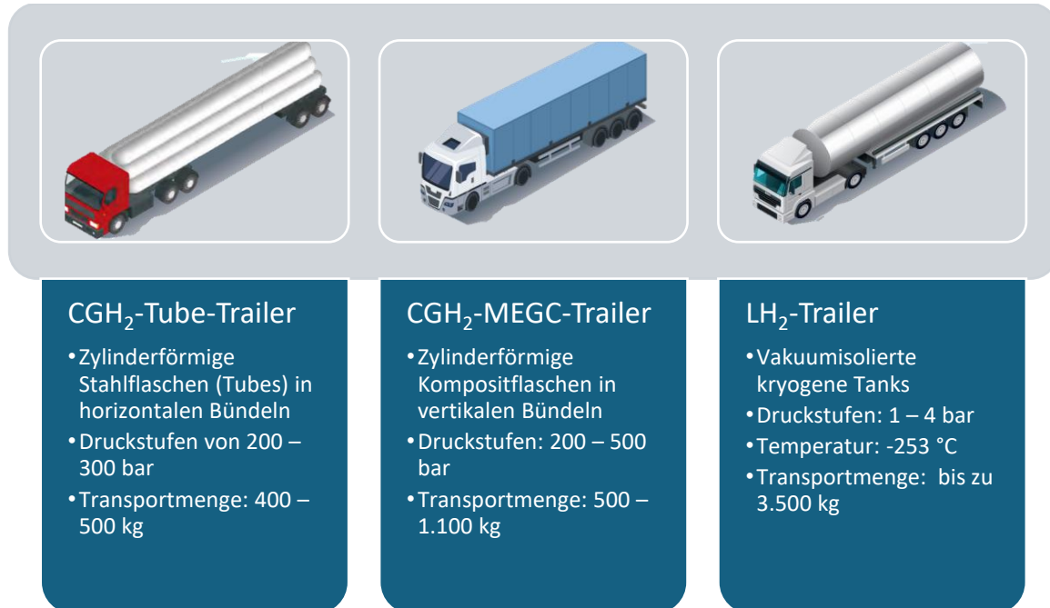
Abbildung 2-4: Transporttrailer für Wasserstoff. Links: GH 2 Tube Trailer, Mitte: CGH 2 -MEGC-Trailer, Rechts: LH 2 -Trailer (5)
