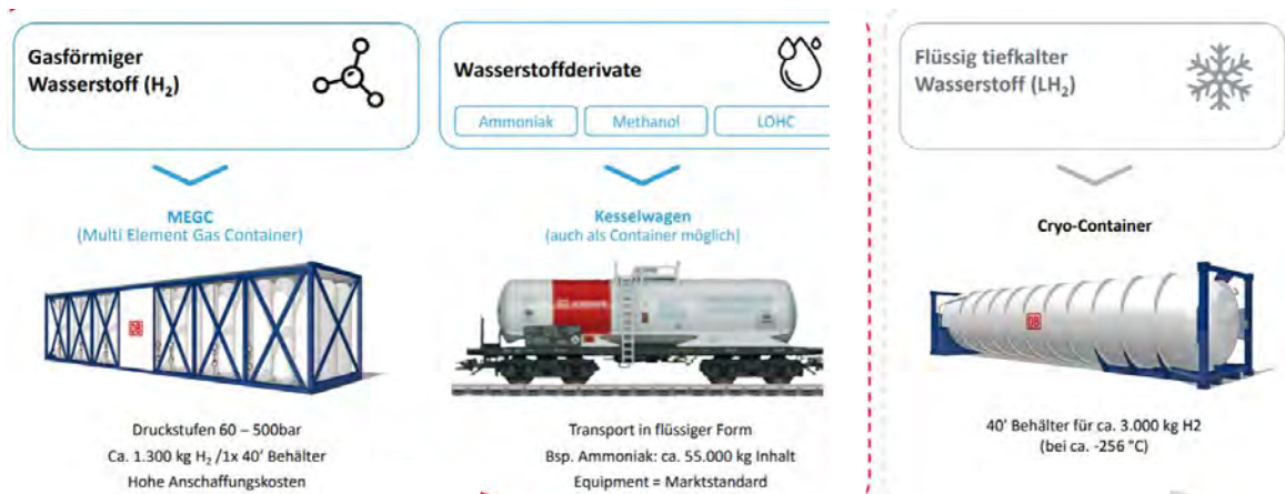
Abbildung 3-20: Formen des schienenengebundenen Wasserstofftransports (35)
